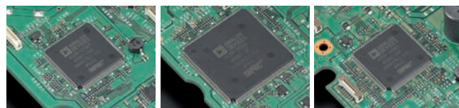
DSP für die Haupt-RX-ZF und den Sender ADSP-21363, mit 333 MHz getaktet
