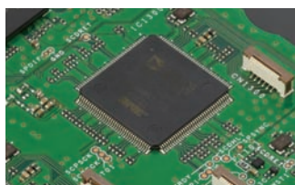
DSP für das Bandkop ADSP-21363, Takt 332 MHz
