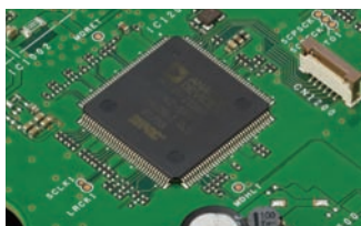
ZF-DSP des Senders ADSP-21363, Takt 332 MHz
