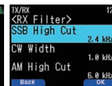
Einstellung der ZF-Filter für den Empfang
