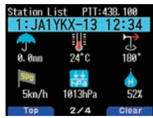
Anzeige der gemessenen meteorologischen Daten einer Wetterstation
