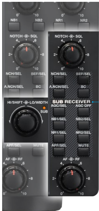
Der Sub-Empfänger mit seinen Bedienelementen für die effektive Unterdrückung von Störungen befindet sich auf der rechten Seite der Frontplatte.
